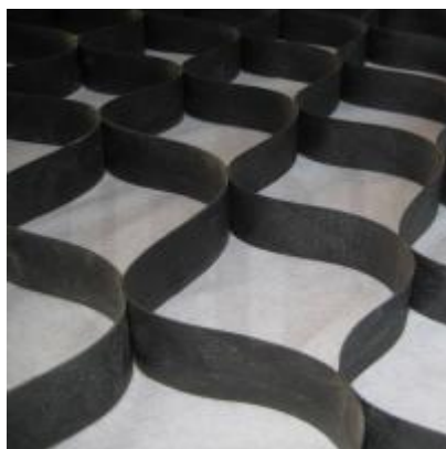
ОР-15 СНО Георешетка облегченная 15см 160x160мм толщина 1,2мм
