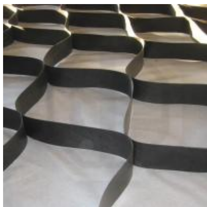
ОР-10 СНО Георешетка облегченная 10см 320x320мм толщина 1,2мм
