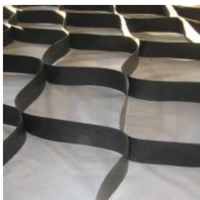
ОР-10 СНО Георешетка облегченная 10см 410x410мм толщина 1,2мм
