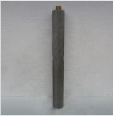
Сетка тканая нержавеющая 0,5x0,5мм, d 0,2мм ГОСТ 3826-82
