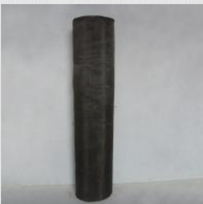
Сетка тканая неоцинкованная 6x6мм, d 1,6мм ГОСТ 3826-82
